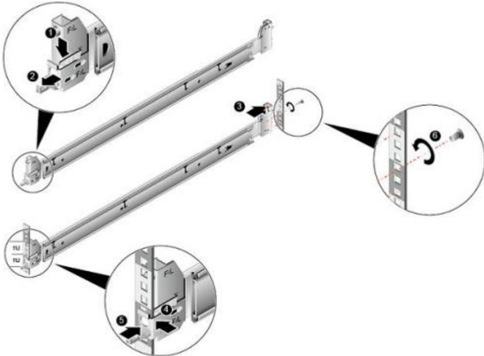
2. 将抱轨后端定位销，插入机柜后侧的立柱孔位，如图 6-10 中③所示。
