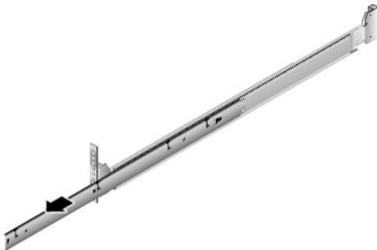
2. 将服务器上的固定钉对准内轨的固定孔位，然后向前推进，直到听见“咔”的一声，确保卡扣弹起完全挡住挂钉，使服务器固定到内轨上，如图 6-12 所示。
