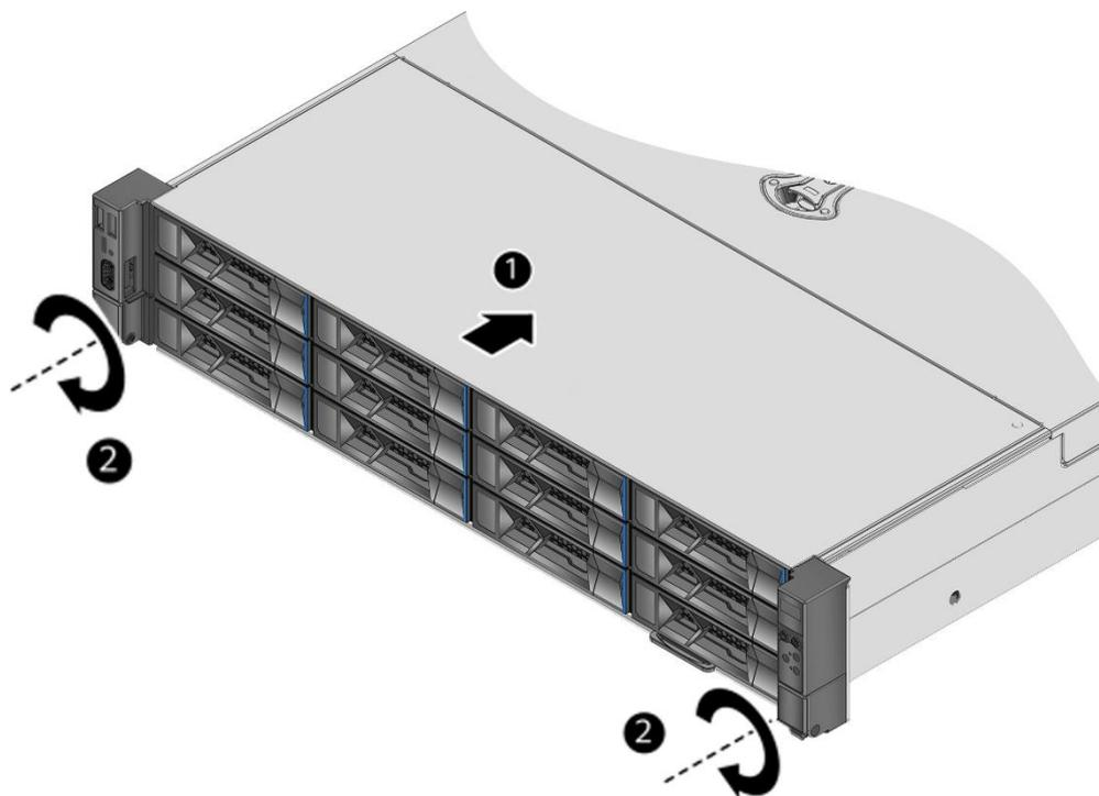
3. 如图 6-9 中②所示，将服务器两侧挂耳紧贴方孔条，按顺时针方向拧紧挂耳上的松不脱螺钉，固定服务器。
