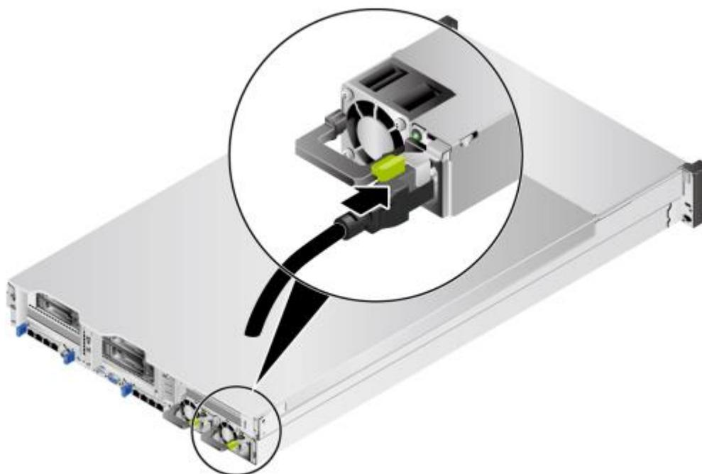
步骤 3 用魔术贴固定好电源线缆，如图 6-20 所示。
