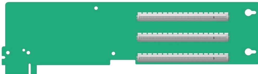
图 3-12 中 Riser 卡可以安装在 IO 模组 1 或者 IO 模组 2 上。安装在 IO 模组 1 时，PCIE 槽位为 Slot 1~Slot 3，安装在 IO 模组 2 时，PCIE 槽位为 Slot 4~Slot 6。其中，Slot 1 或 Slot 4 为预留槽位，暂不支持，具体上件情况以实物为准。
