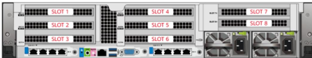
IO 模组 1 提供的槽位为 Slot 1~Slot 3；IO 模组 2 提供的槽位为 Slot 4~Slot 6；IO 模组 3 提供的槽位为 Slot 7~Slot 8。
