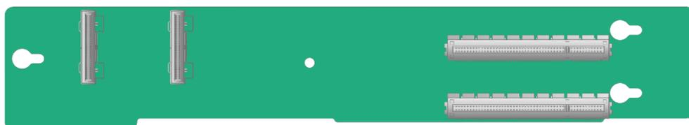
当图 3-14 中的 Riser 卡安装在 IO 模组 3 时，PCIE 槽位为 Slot 7 和 Slot 8。
