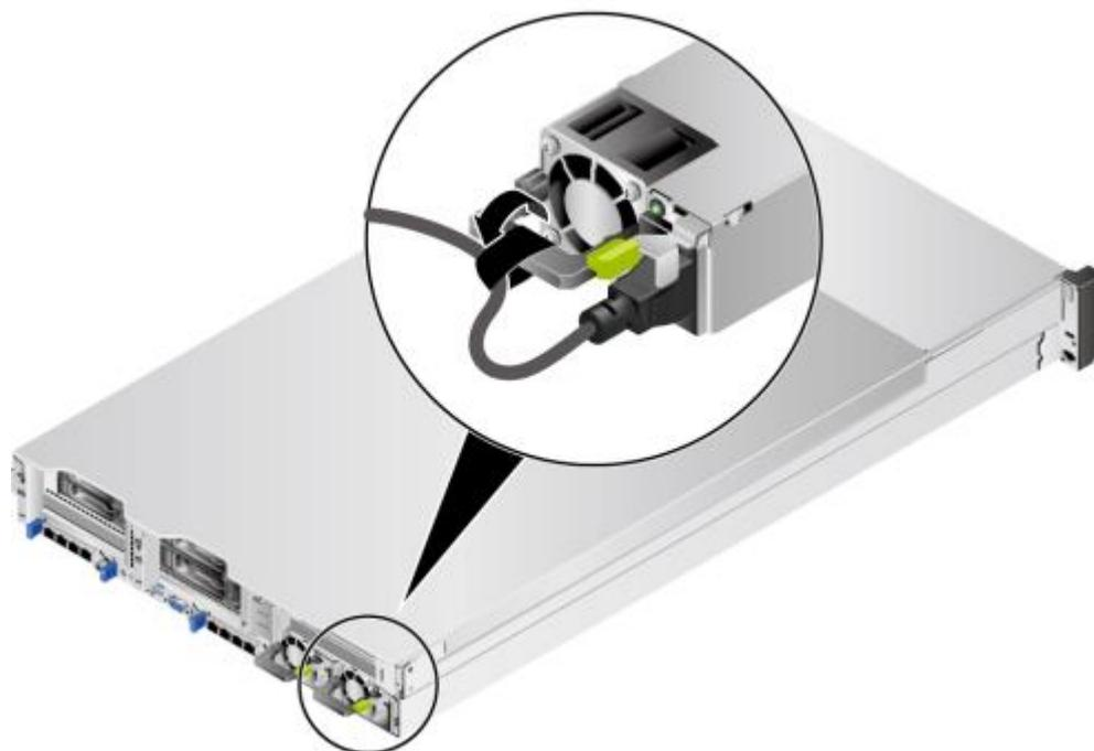
步骤 4 将电源线的另一端插入机柜的交流插线排。交流插线排位于机柜后方，水平固定在机柜上。按照规划选择合适的交流插线排上的插孔插入电源线。
