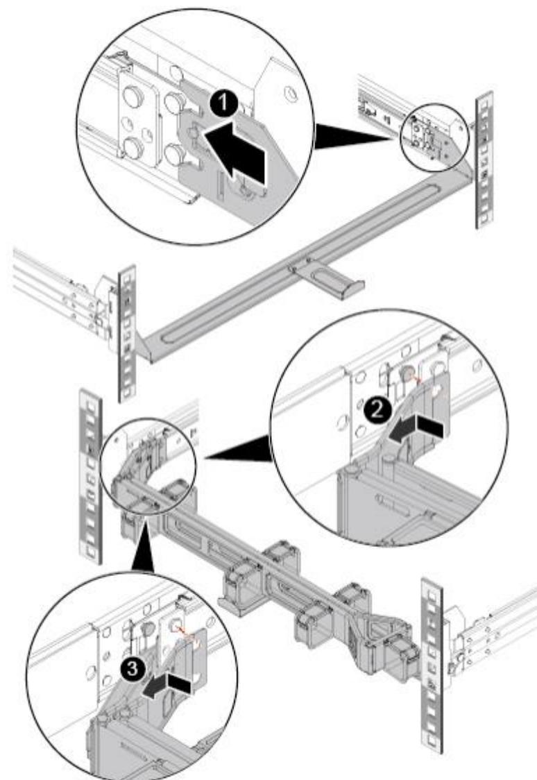
2. 将理线架支架的外壁卡入左侧外轨的固定钉中，并沿箭头方向拉固定理线架，如图 6-15 中②所示。
