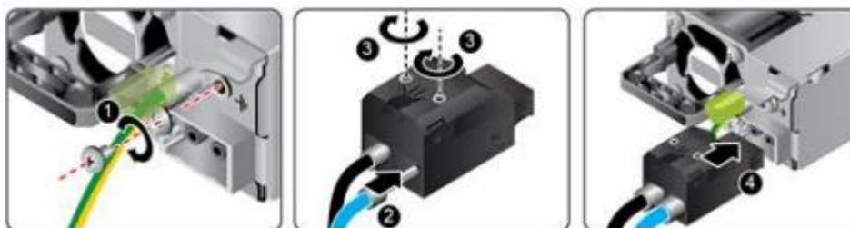
步骤 4 将电源模块线缆的另一端插入机柜的直流插线排。
