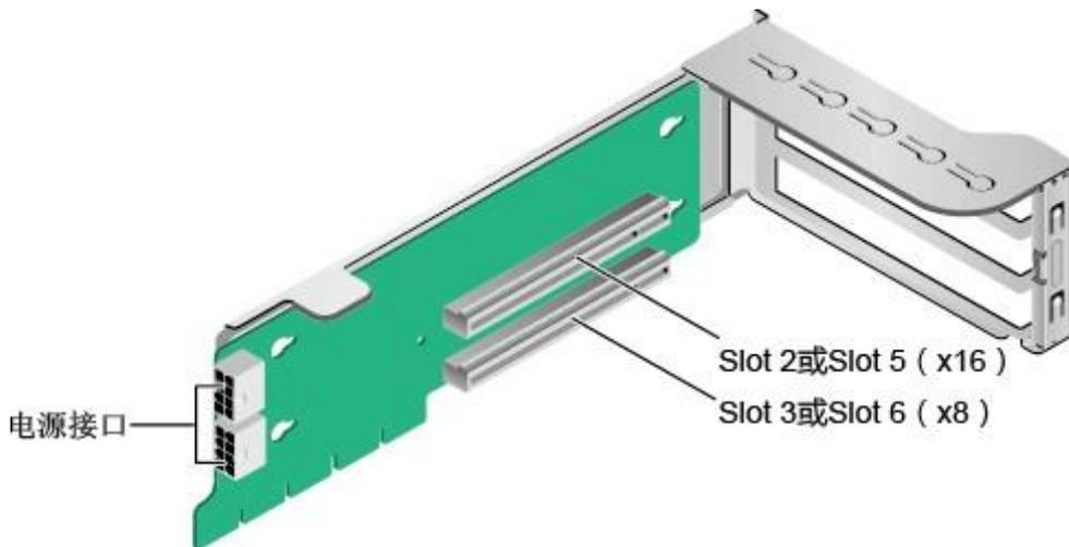
当 IO 模组 1 和 IO 模组 2 分别配置 2\*2.5 英寸后置硬盘时, IO 模组 1 和 IO 模组 2 可同时支持安装x16提升卡, 如图 4.11 所示。当 Riser 卡安装在 IO 模组 1 时, PCIe 槽位为 Slot 3, 当安装在 IO 模组 2 时, PCIe 槽位为 Slot 6。
