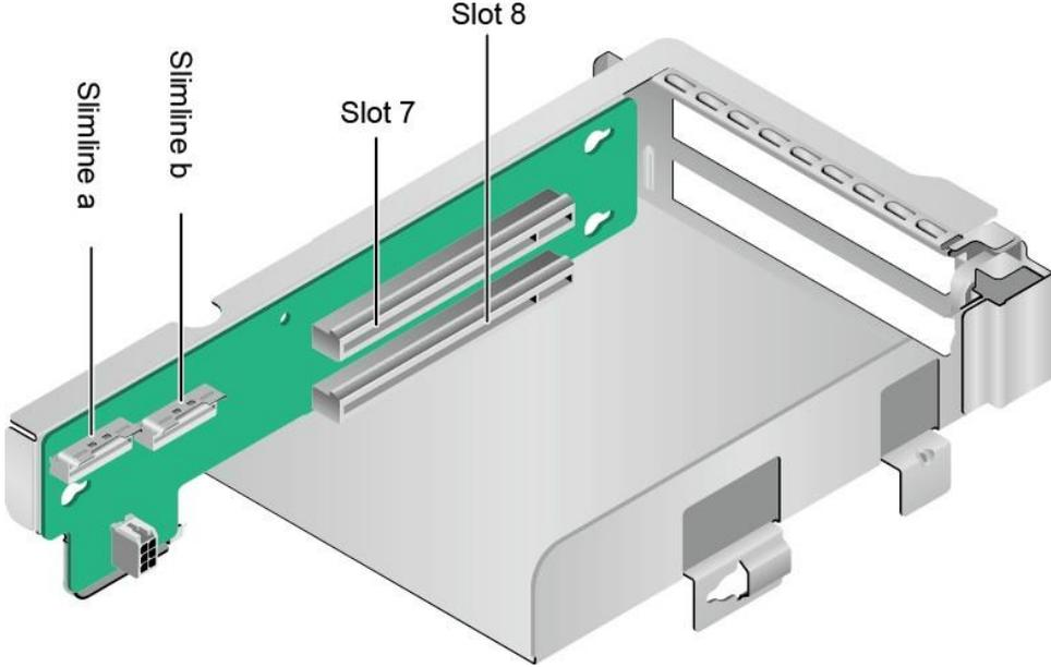
当图 4.15 中 Riser 卡安装在 IO 模组 3 时，PCIe 槽位为 Slot 8。
