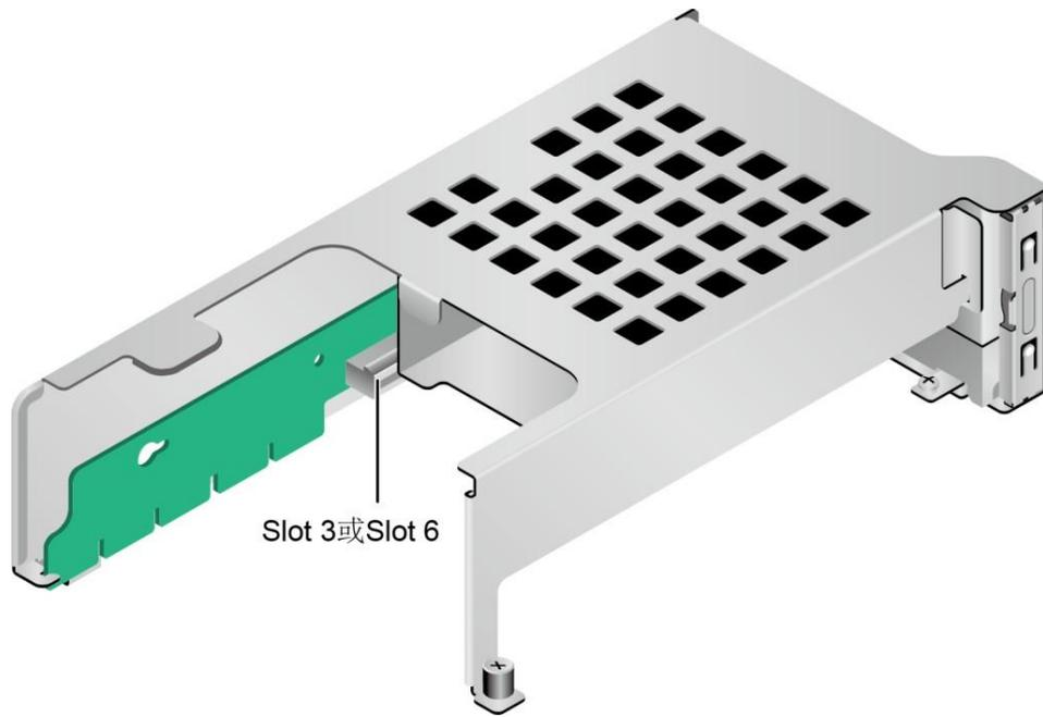
图 4.12 中 SAS Riser 卡可以安装在模组 1 或者模组 2 上，默认安装在 IO 模组 2 上。安装在 IO 模组 1 时，占用 Slot 1~Slot 3 的 PCIe 槽位，其中 Slot1，Slot2 无输出，Slot3 支持 x8 信号；安装在 IO 模组 2 时，占用Slot 4~Slot 6 的 PCIe 槽位，其中 Slot4，Slot5 无输出，Slot6 支持 x8 信号。
