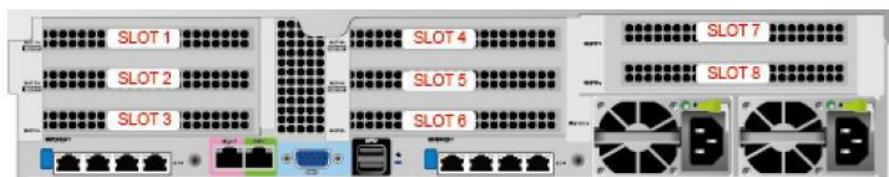
IO 模组 1 提供的槽位为 Slot 1~Slot 3；IO 模组 2 提供的槽位为 Slot 4~Slot 6；IO 模组 3 提供的槽位为 Slot 7~Slot 8。
