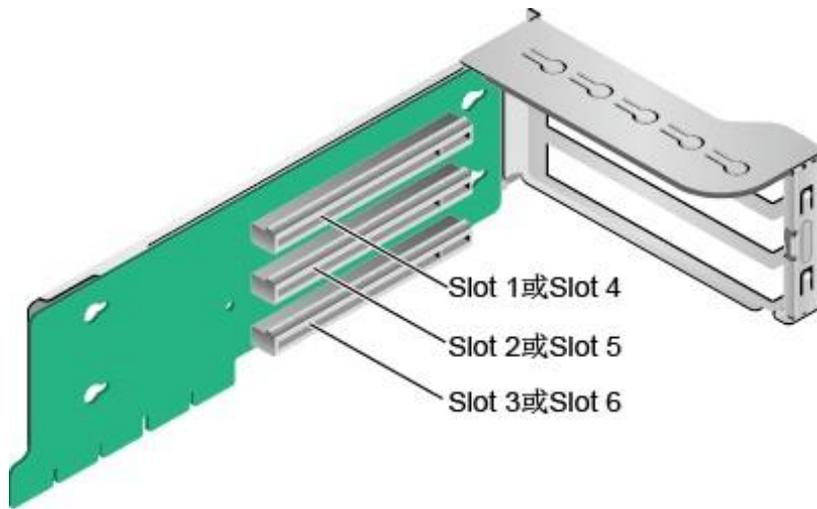
图 4.10 中 Riser 卡 2 (1x8+1x16) 支持全高全长双宽 GPU 卡, 当 Riser 卡安装在 IO 模组 1 时, PCIe 槽位为 Slot 2 和 Slot 3, 当安装在 IO 模组 2 时, PCIe 槽位为 Slot 5 和 Slot 6。
